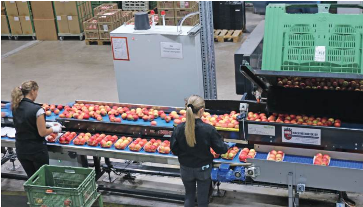
Die sortierten Äpfel gelangen auf verschiedene Linien, abhängig von der Verpackungsart.
