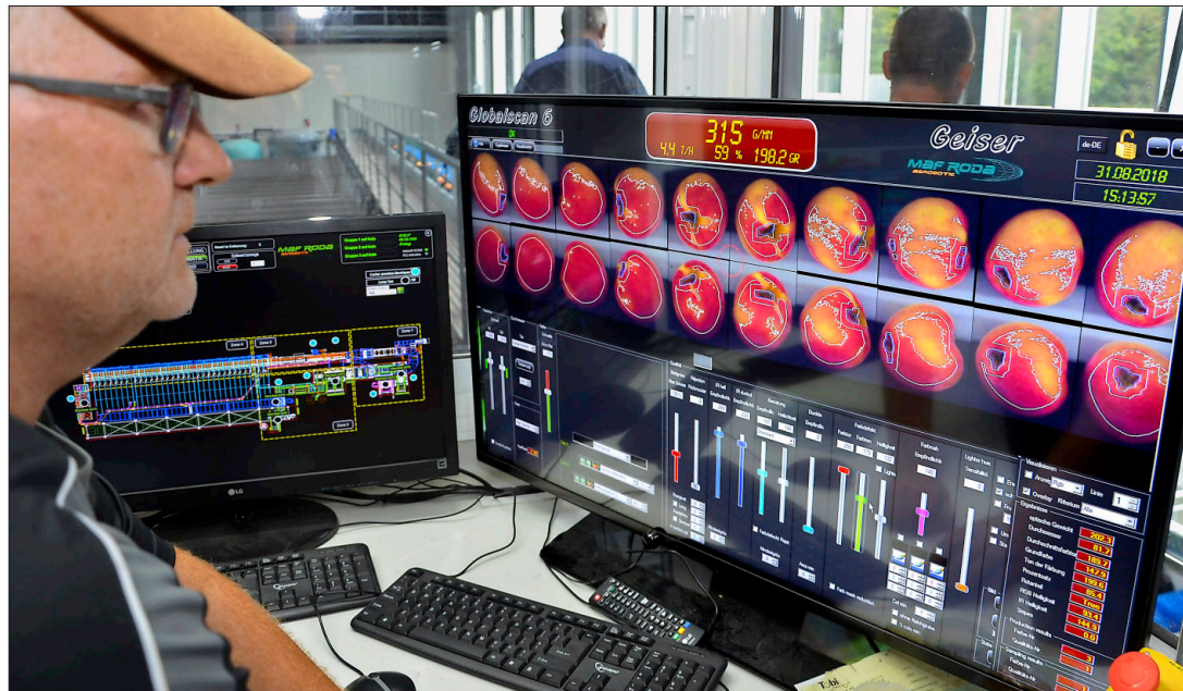
Vollautomatische Sortierung des Tafelobstes nach Grösse und Farbanteil. Jeder Apfel wird einzeln mit Infrarot gescannt und definierten Qualitätsklassen zugewiesen. (Bild: rh)
